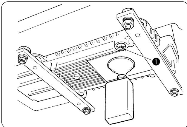
En el caso de una máquina de coser nueva, reemplace el aceite lubricante (JUKI GENUINE OIL 18) con uno nuevo después de haber utilizado la máquina durante un mes aproximadamente. Luego, reemplace el aceite lubricante cada seis meses.
