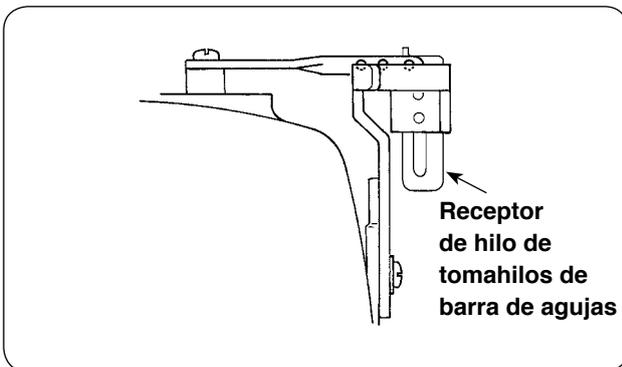
El receptor de hilo del tomahilos de la barra de agujas se alinea con el extremo superior del tomahilos de la barra de agujas cuando la barra de agujas se encuentra en su punto muerto inferior.
