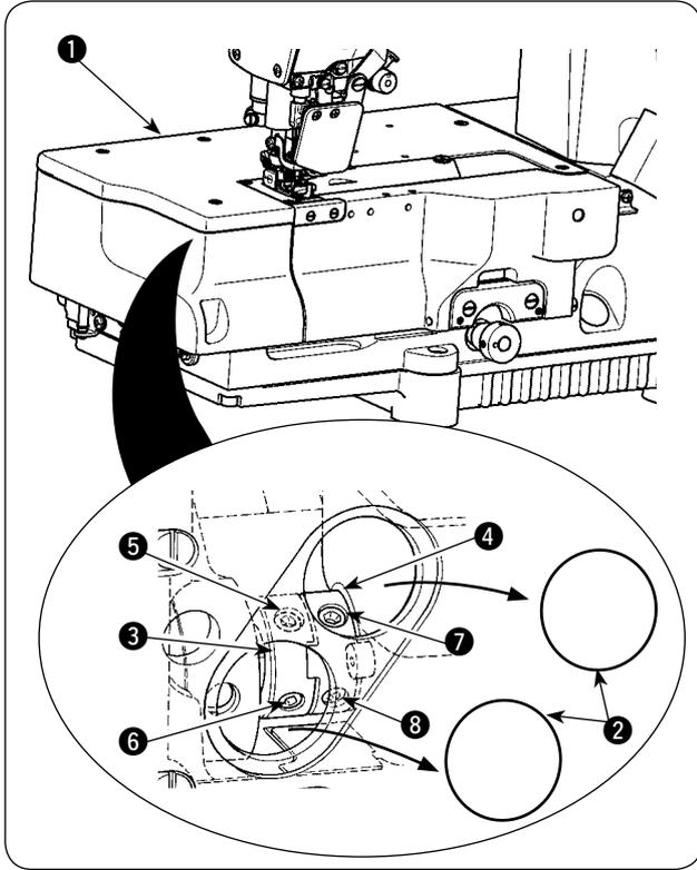
La sincronización de la leva excéntrica de accionamiento del transporte se puede retardar en 10° con respecto al ajuste estándar.
