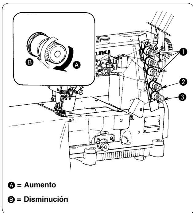
Ajuste la tensión de los hilos mediante las siguientes tuerca tensoras de hilos.
