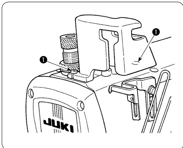
Instale sobre el brazo de la máquina la cubierta del tomahilos de la barra de agujas suministrada con la unidad, utilizando para ello los dos tornillos ❶.
