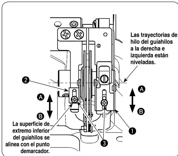
Cuando se desee disminuir la cantidad del hilo que se extrae en el caso de la máquina de 2 agujas o similar, afloje los tornillos ③, mueva hacia arriba los guíahilos ① y ②, y apriete los tornillos ③ para fijarlos.
