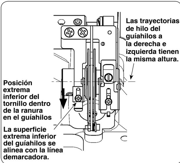
Posición extrema inferior del tornillo dentro de la ranura en el guíahilos
