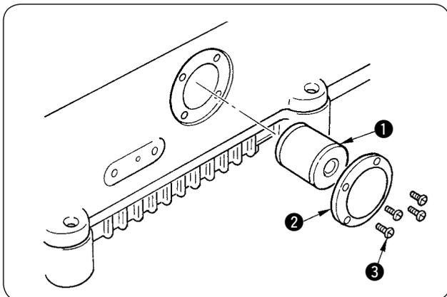
La lubricación no puede llevarse a cabo normalmente si hay polvo acumulado en el filtro de aceite ①. Inspeccione el filtro cada 6 meses.
