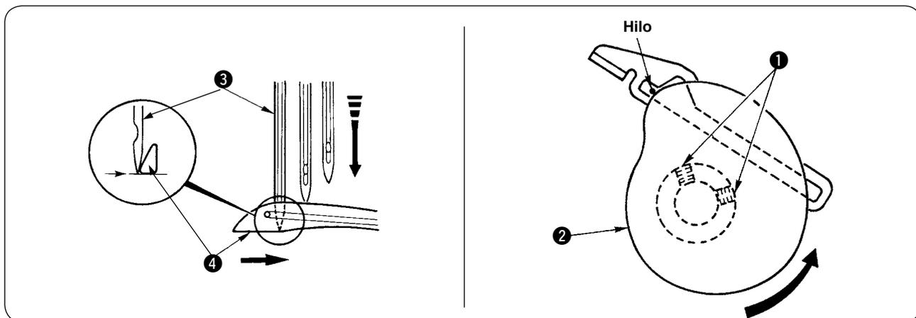
Haga el ajuste de manera que el hilo se suelte desde el punto más alto de la leva ② del hilo del enlazador cuando las agujas descendan y el extremo superior de la aguja izquierda ③ se alinee con la superficie inferior del enlazador ④. Luego, apriete el tornillo ① para fijar la leva del hilo del enlazador.
