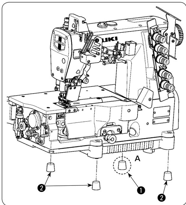
Instale la goma gris a prueba de polvo en la sección A solamente.
