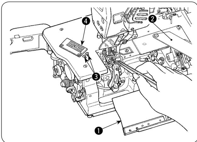
Abra la cubierta ① y deslice la cubierta ②, saque el tornillo ③ y desmonte la placa de agujas ④. Seguidamente limpie las ranuras en la placa de agujas, y las de los dentados de transporte, y las periferias.
