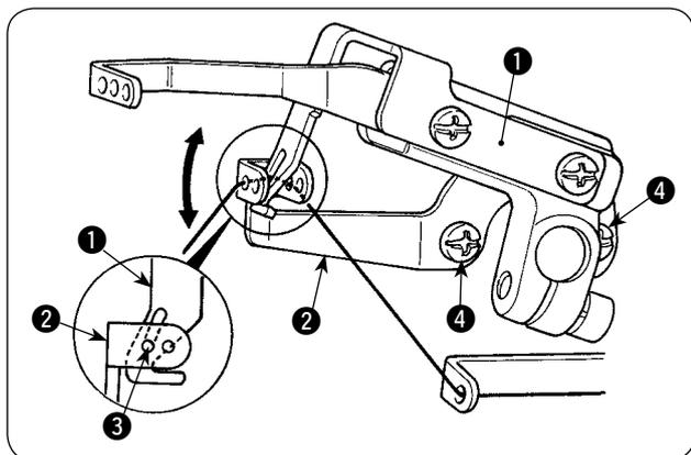
Haga el ajuste de manera que el extremo superior de la trayectoria (trasera) del hilo ③ del guíahilos ② de la estiradora se alinee con la superficie inferior de la ranura del tomahilos ① de la estiradora cuando el tomahilos ① de la estiradora se encuentre en su posición más alta. Luego, apriete el tornillo ④ para fijar el guíahilos de la estiradora.
