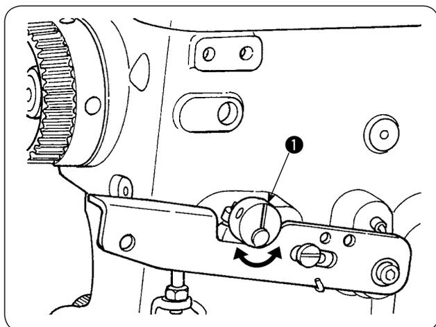
Cuando el collarín del microelevador ❶ se gira en el sentido de las manecillas del reloj o en el sentido opuesto a las manecillas del reloj, la palanca de elevación de la barra prensadora es presionada para elevar el prensatelas. Ajuste la altura del microelevador de acuerdo con las condiciones de cosido.
