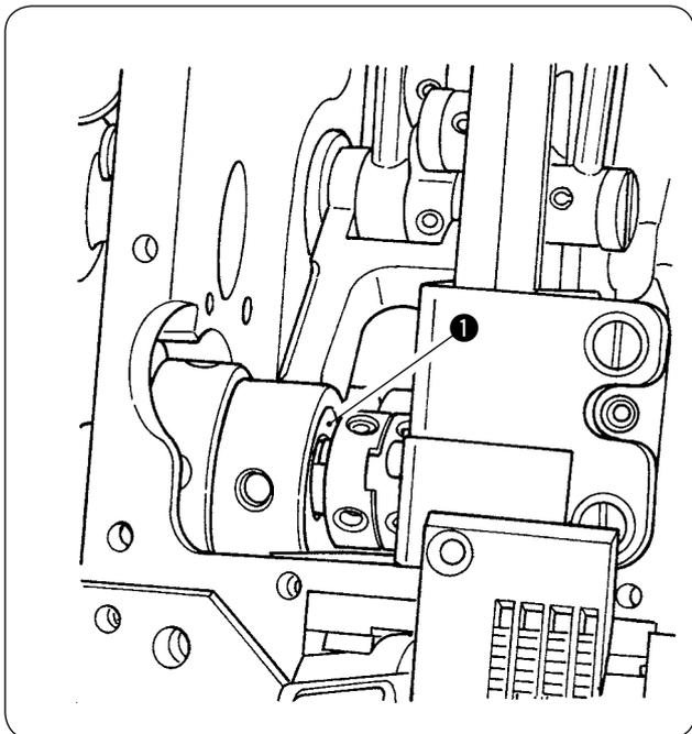
La sincronización de la leva excéntrica 1 de accionamiento del transporte se puede retardar en 10° con respecto al ajuste estándar.
