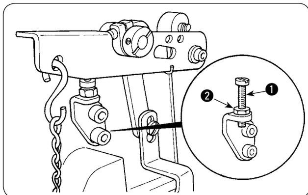
Para ajustar la altura del pie prensatelas, ajuste la altura del tornillo ❶ de manera que el pie prensatelas no entre en contacto con otros componentes, y fije el pie prensatelas con la tuerca ❷.
