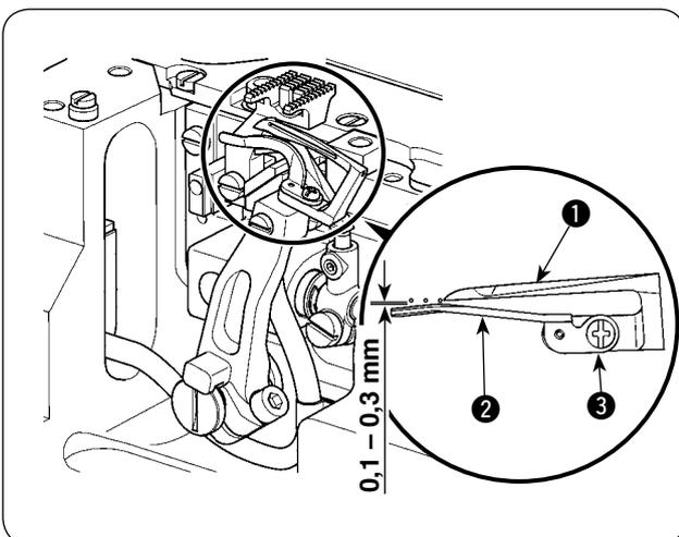
Haga el ajuste de manera que la separación entre las agujas y el guardaagujas frontal 2 sea de 0,1 a 0,3 mm cuando el enlazador 1 se desplaza de su posición extrema derecha a la izquierda y pasa por el lado trasero de las respectivas agujas. Luego, fije el guardaagujas frontal con el tornillo de fijación 3.
