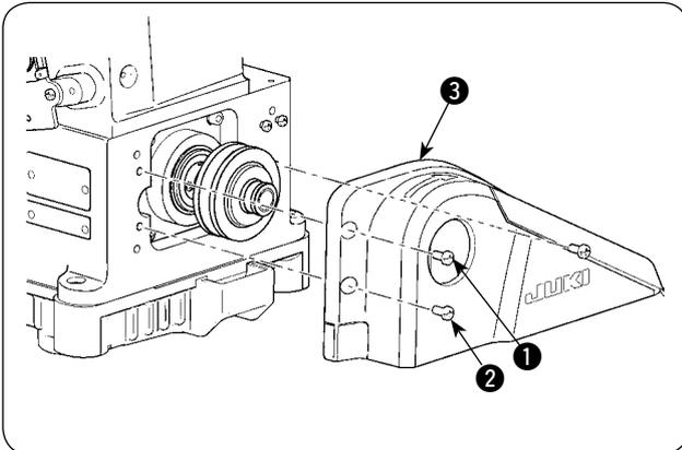
Instale la cubierta **3** de la correa tal como se muestra en la ilustración.
