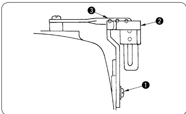
Afloje el tornillo de fijación ① y haga el ajuste de manera que el extremo inferior del centro del agujero del hilo del tomahilos ③ de la barra de agujas quede alineado con el extremo superior del receptor de hilo ② del tomahilos de la barra de agujas cuando la barra de agujas se encuentra en su posición más baja. Luego, apriete el tornillo ① para fijar el receptor de hilo del tomahilos de la barra de agujas.
