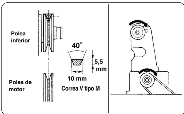
Use un motor de embrague trifásico, 2 polos, 400 W (1/2 HP). Use correa en V tipo M.
