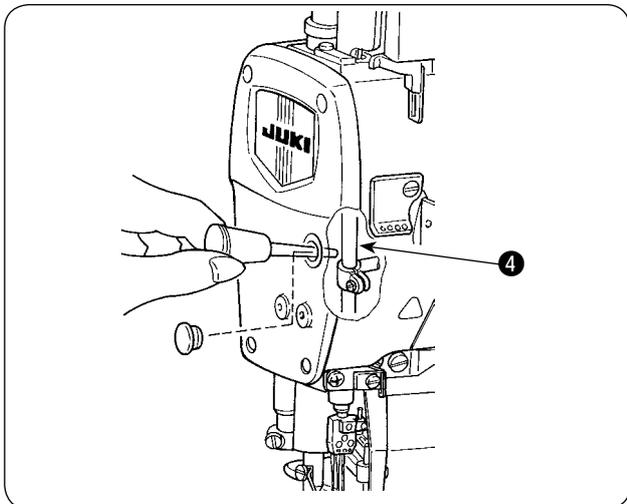
Cuando utilice la máquina por primera vez o después de un período prolongado de desuso, asegúrese de aplicar de 2 a 3 gotas de aceite lubricante a la barra de agujas ④. Utilice el JUKI GENUINE OIL 18 como aceite lubricante.
