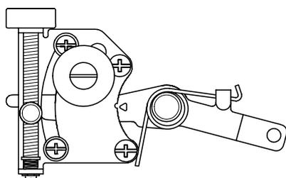
Afloje la tuerca de seguridad diferencial ① y mueva la palanca ② hacia arriba para incrementar la relación de transporte diferencial; esto hace que se frunza el material de cosido.
